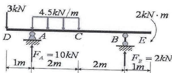
五. T字形截面铸铁梁的荷载及截面尺寸如图示，C为T形截面的形心，惯矩  $I_z=6013 \times 10^4 \text{mm}^4$ ，材料的许可拉应力  $[\sigma_t]=40 \text{MPa}$ ，许可压应力  $[\sigma_c]=160 \text{MPa}$ ，试校核梁的强度。(20分)
