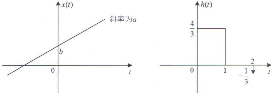
正确写出  $x(t)$  与  $h(t)$  的时域表达式, 并带入卷积公式求解出响应  $y(t)$ 。2. 已知  $x(t)$  的傅里叶变换为  $X(j\omega)$ ,(a) 将  $x_1(t) = x(t-1)$  的傅里叶变换用  $X(j\omega)$  来表示; (4 分)(b) 试将  $x_2(t) = \frac{d}{dt}[x(t-1)]$  的傅里叶变换用  $X(j\omega)$  来表示。 (2 分)(c) 试将  $x_3(t) = \frac{d^2}{dt^2}[x(t-1)]$  的傅里叶变换用  $X(j\omega)$  来表示。 (2 分)
